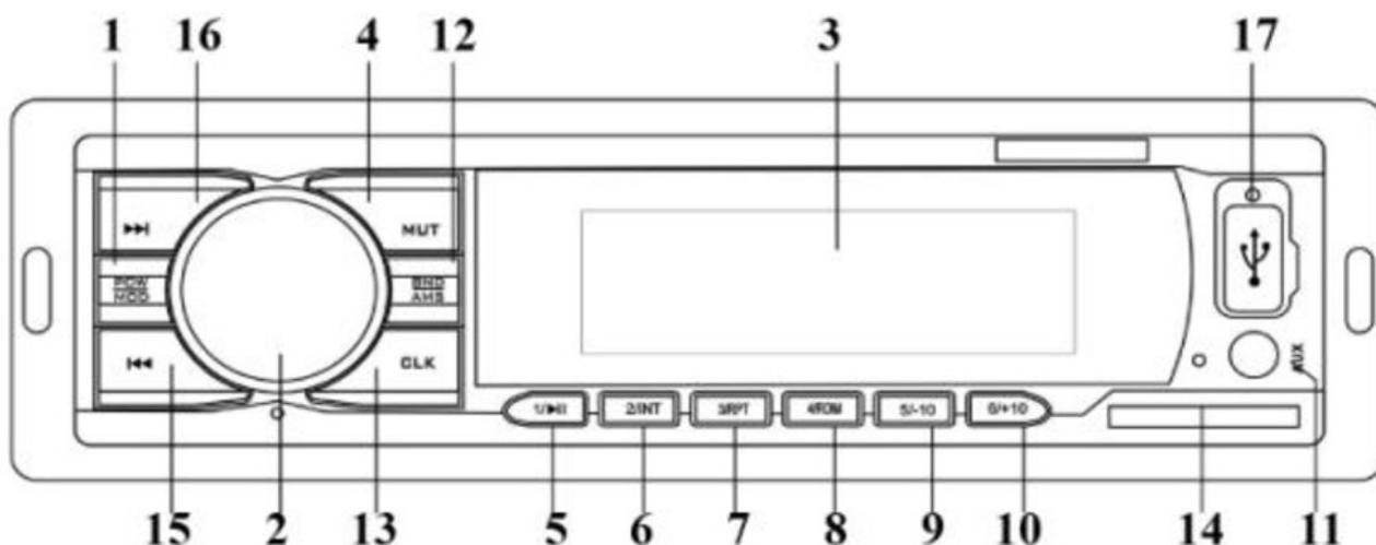
1. Кнопка **PWR/MOD** включение/выключение питания Устройства / переключение режимов работы;
