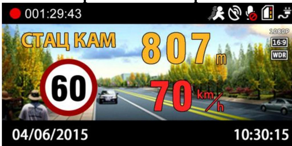
Когда скорость автомобиля превышает значение ограничения скорости на данном участке, передается подсказка «Будьте внимательны, вы уже превысили скорость», в это же время скорость автомобиля на экране меняется на красный цвет.
