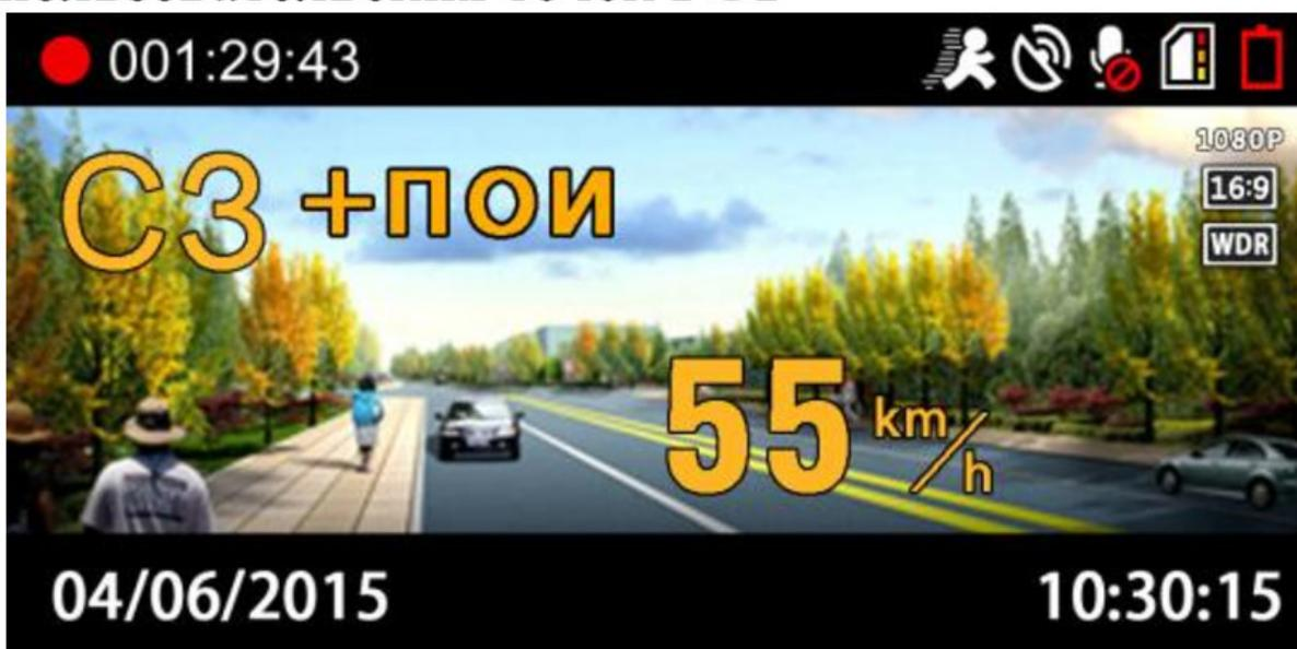
В случае обнаружения нового радара есть возможность самостоятельно добавить его в базу данных устройства. В дальнейшем, приближаясь к данной точке, можно будет получать предупреждение. Находясь рядом с новым радаром, при работающем gps-приёмнике, нажмите и удерживайте кнопку «Вверх». Как только новая точка POI будет добавлена, устройство даст подтверждение.
